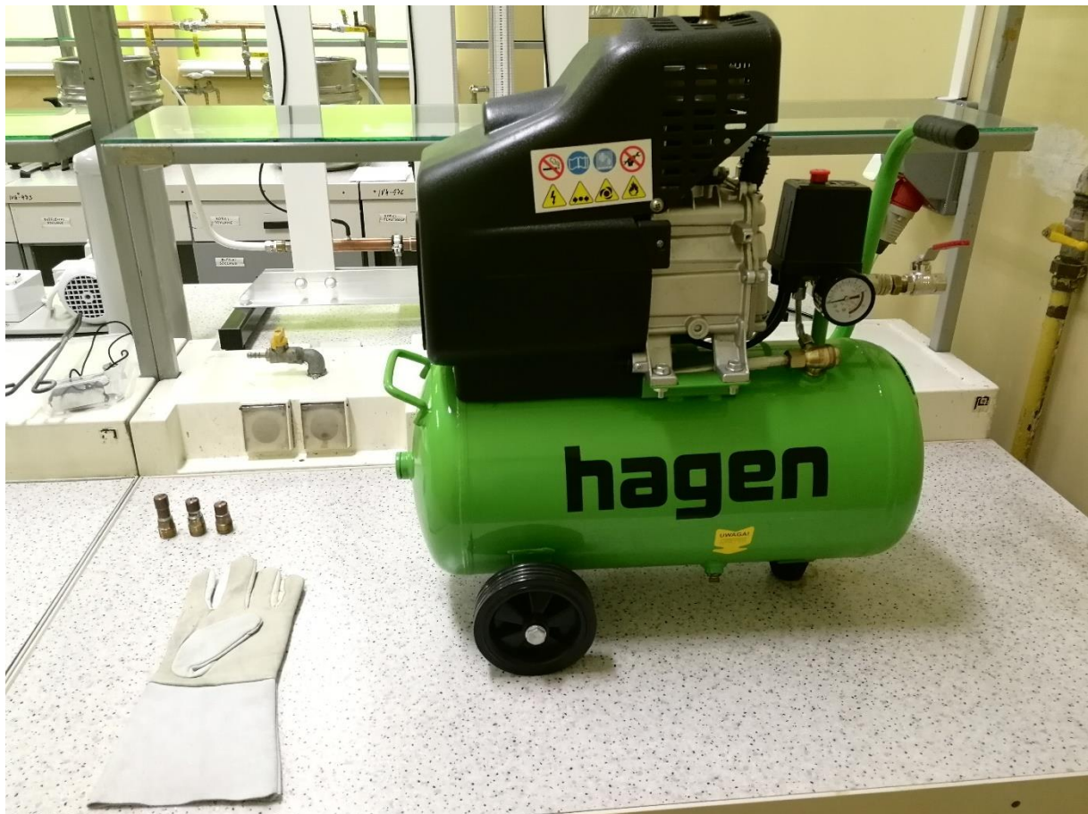
Rys. 5 Agregat sprężarkowy jako stanowisko pomiarowe
